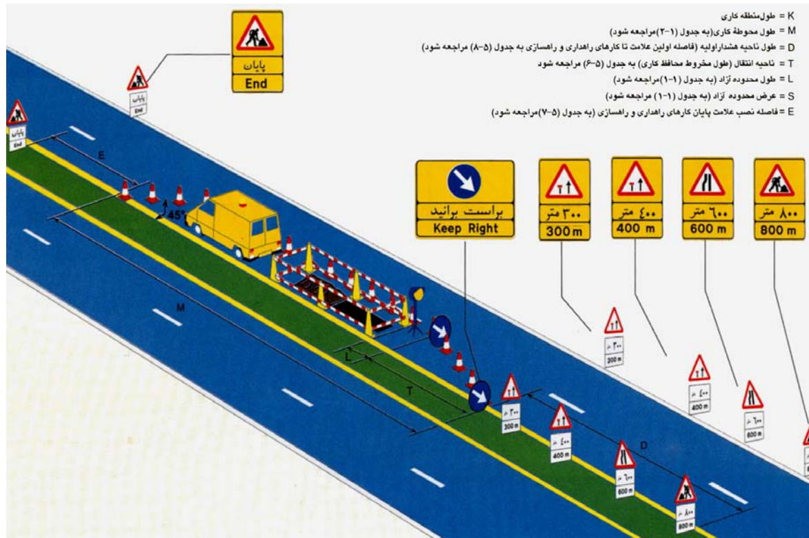
شکل ۲-۱۲- طرح علائم‌گذاری در یک راه شریانی چهارخطه با جدا کننده وسط که یک خط کناری آن بسته است.
