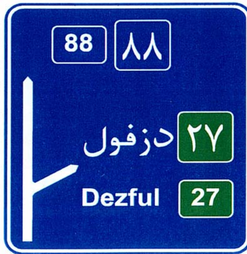
شکل ۶-۳- علامت پیش‌آگاهی جهت‌نمای مقدماتی (Forward) در یک آزادراه
