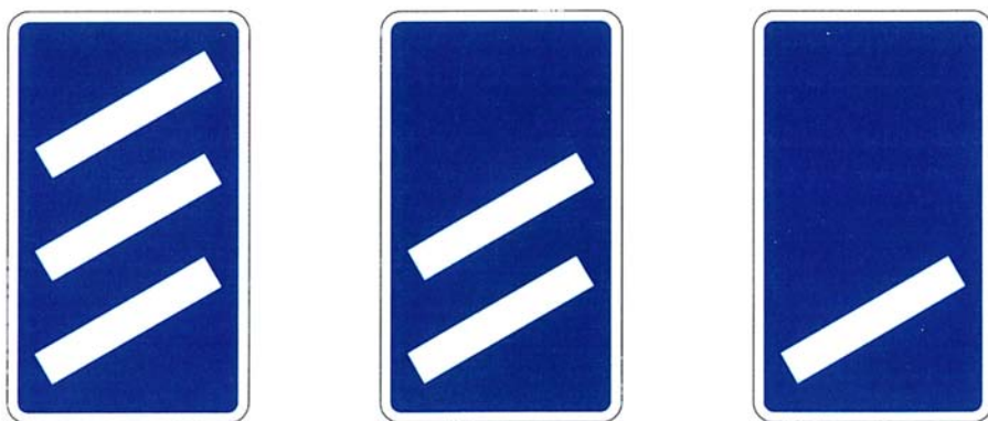
شکل ۶-۵۰- پایه‌های تقلیل فاصله به فواصل صد متری تا یک خروجی از یک آزادراه یا راه درجه یک
